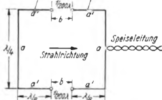
Bild 2. Geknickte Dipol-Richtantenne mit Reflektor und einseitiger Strahlung.
