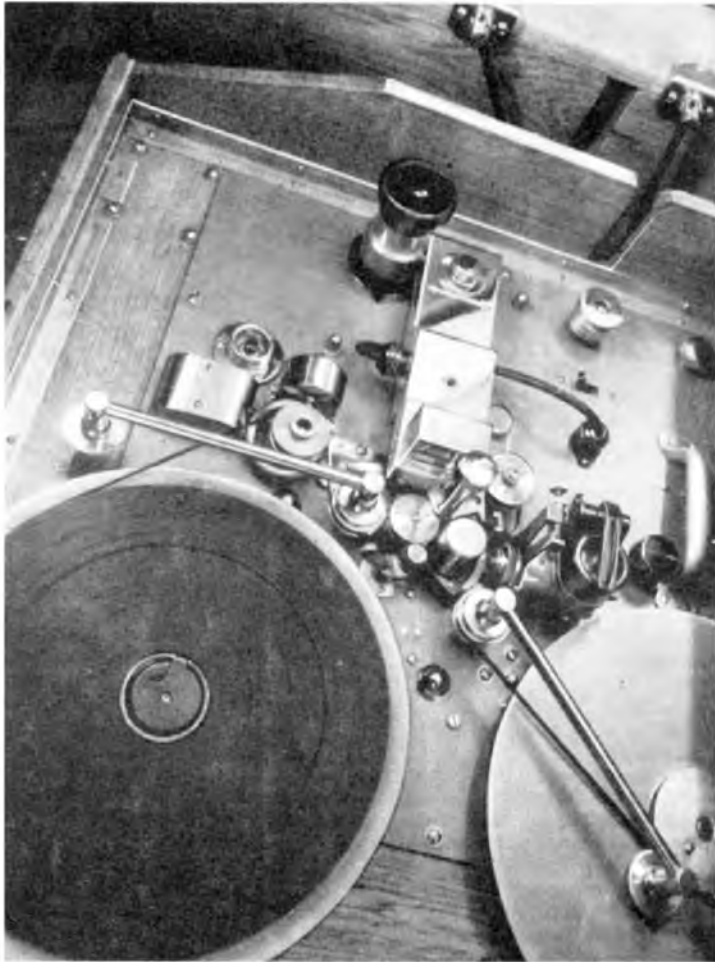
Das Aufnahmegerät in dem Tonaufnahmewagen. Die Aufnahme kann jederzeit augenblicklich beginnen oder aufhören — der Antriebsmotor läuft ununterbrochen weiter. Mit Hilfe eines Druckknopfes läßt sich der Tonstreifen in Bewegung setzen oder abstoppen; gleichzeitig wird der Stichel auf den Aufnahme-streifen gesenkt oder von ihm abgehoben.
