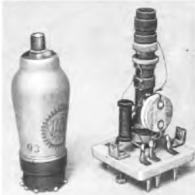
Das Bild zeigt die Größe eines der neuen Spulensätze im Vergleich zu einer Röhre.
